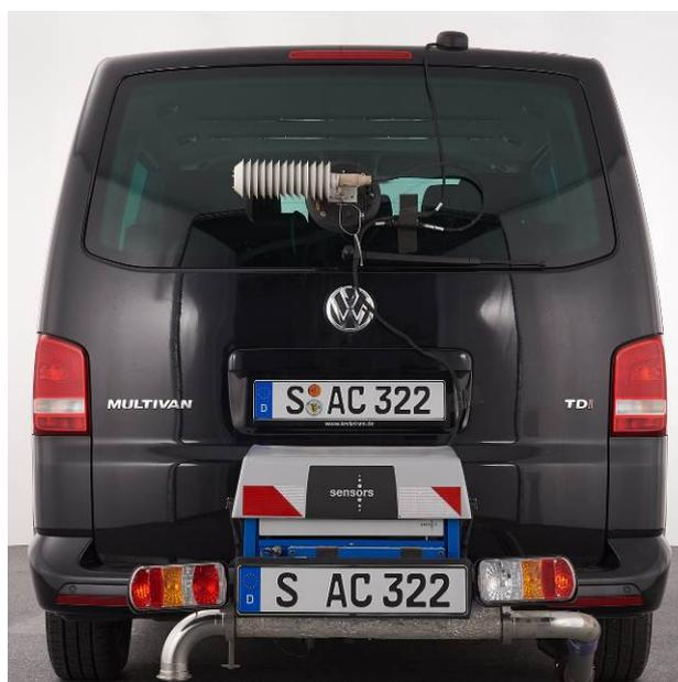
Abbildung 8 VW T5 mit mobiler Abgasmessanlage (PEMS)
