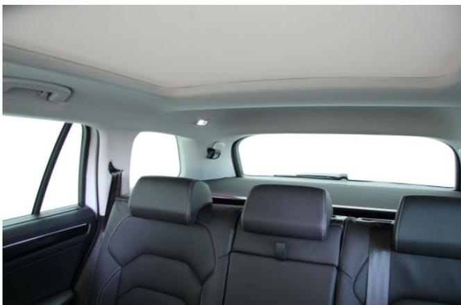
Die breiten Dachsäulen und das schmale, hoch angesetzte Heckfenster schränken die Sicht nach hinten stark ein.
