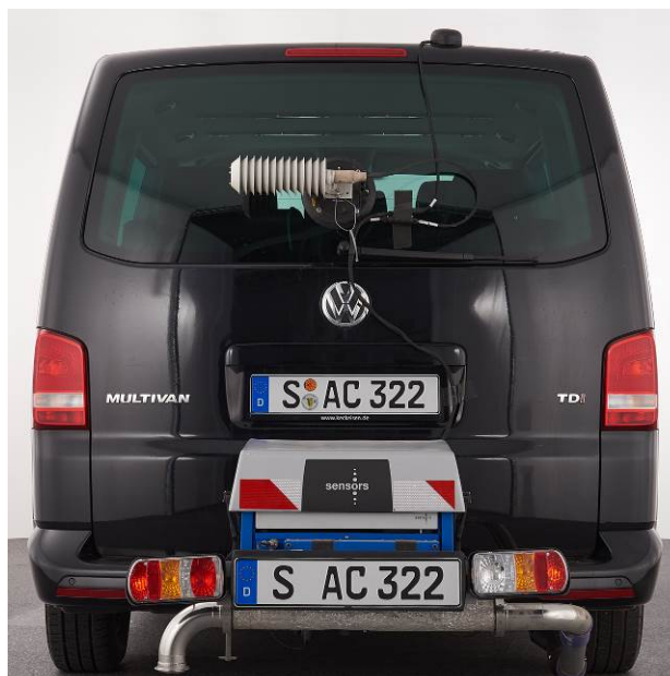
Abbildung 5 VW T5 mit mobiler Abgasmessanlage (PEMS)
