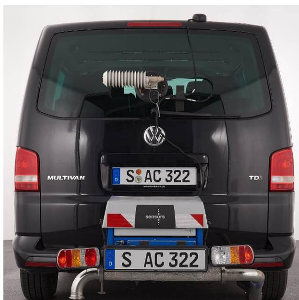
Abbildung 5 VW T5 mit mobiler Abgasmessanlage (PEMS)
