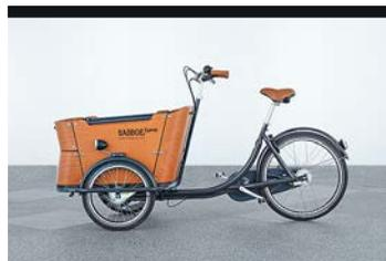
**Die Box** schützt beim Einschlag, das Rad schlittert dann aber mit der glatten Seitenwand weiter. Durch den Aufprallwinkel und einen sich lösenden Gurt wurden beim Crash im Brustbereich die höchsten Belastungen im Test gemessen.
