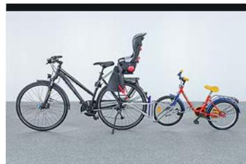
**Beim Crash** ist das Kind auf dem Nachläufer ungeschützt. Zwar sind die Belastungen beim Aufprall nur leicht erhöht. Die Verletzungsgefahr für das Kind durch den folgenden Sturz auf den Asphalt und das Weiterschleudern ist aber enorm.
