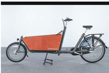
**Der Lenker** stößt im Test bereits bei normalen Lenkbewegungen an die Köpfe. Die Box schützt beim Aufprall, das Rad fällt allerdings um und schlittert auf der glatten Seitenwand der Box nach dem Crash weiter. Gute Werte beim Komfort.
