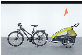
**Der Rahmen** des Fahrradanhängers bleibt beim Crashversuch komplett intakt, auch die Gurte halten. Durch den Aufprall im unteren Bereich sind jedoch die Belastungen für die Kinder bei der Kollision mit dem Pkw relativ hoch.
