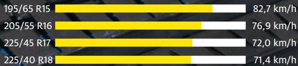
Aufschwimmgeschwindigkeit Längsaquaplaning (Winterreifen)
