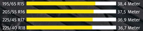
Mittlere Bremswege in Metern von 100 bis 0 km/h (je 16 Sommerreifen)
