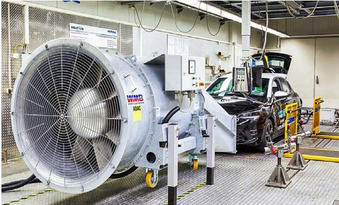
**Auf der Rolle** Ein Opel Corsa während des Green-NCAP-Abgastests
