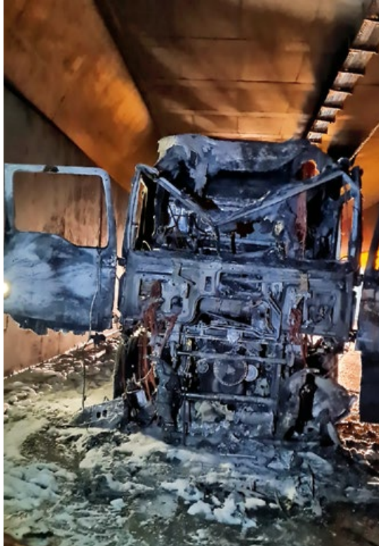
Der Lkw-Brand hat Schäden an Fahrbahn, Decke und Lampen verursacht
