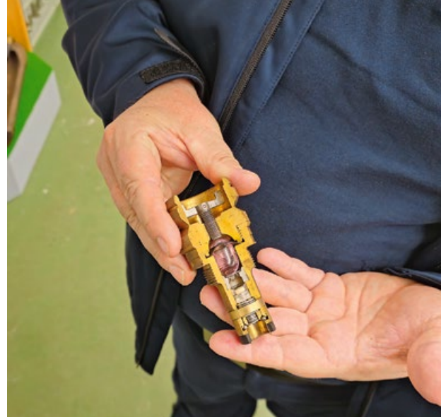
Sprengmeister Holger Klemig zeigt einen Schnitt in einen Langzeitzünder
