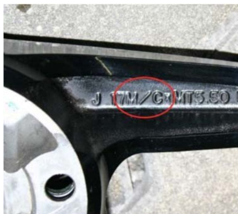
Bild 2: Reifen mit einer M/C-Kennzeichnung dürfen nur auf Motorradfelgen mit einem „M/C“ montiert werden.
