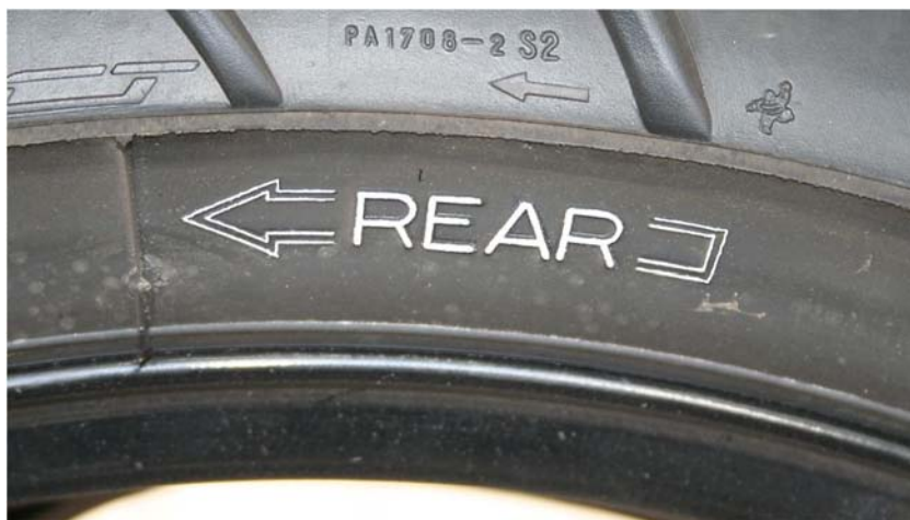
Bild 4: Vorgeschriebene Radposition und Drehrichtung des Reifens
