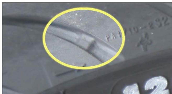
Bild 5: Die Restprofiltiefe eines Reifens wird an verschiedenen Stellen der Lauffläche neben den sogenannten „Treadwear Indicator“ (TWI) gemessen.
