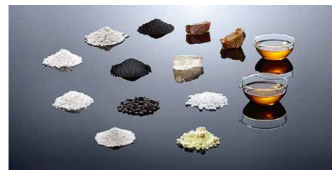
Die verschiedenen Inhaltsstoffe eines Reifens.
