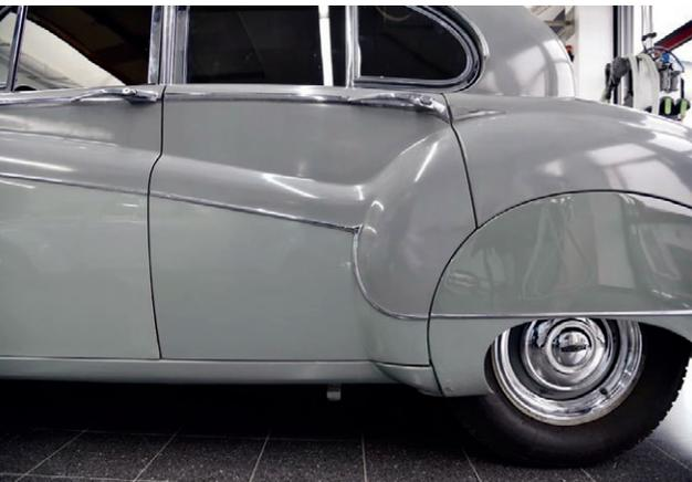
Abbildung 1: Fahrzeug in Zweifarbenlackierung. Der Jaguar MK 9 war das Messefahrzeug von Glasurit bei der Techno Classica 2018. Insgesamt weisen die einzelnen Fahrzeugteile jedoch etwa 20 unterschiedliche Nuancen/Varianten auf. Dokumentiert war wie so oft fast nichts zu den bisherigen Lackierarbeiten.
