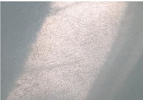
Abbildung 3: Panhard: Rissiger Lack an einem Panhard Dyna X Baujahr 1949 – vermutlich die Erstlackierung. Die Schutzwirkung der Lackierung ist noch immer gegeben. Der kulturelle Aspekt genießt Vorrang vor der Notwendigkeit zur Reparatur dieser Oberfläche. Bei sachgemäßer Lagerung oder Konservierung kann dieses Fahrzeug noch eine lange Zeit überdauern.
