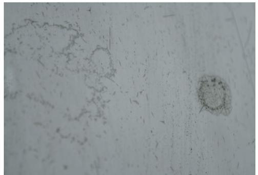
Abbildung 4: Lackierung eines Porsche 911 aus dem Südwesten der USA. Die Oberflächenschäden können mit schwarzem Kontrollpulver sehr gut sichtbar gemacht werden. Der Lack ist teilweise rissig und durch Sonneneinstrahlung und Säure zerstört, möglicherweise auch durch Insekten und/oder Vogelkot.
