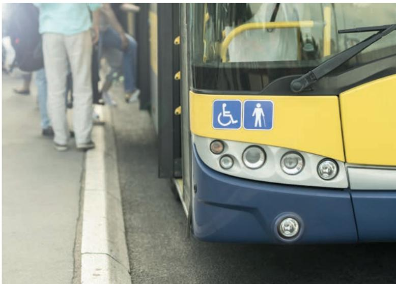
An mindestens einem Zugang des Fahrzeugs ist eine fahrzeuggebundene Einstiegshilfe (z.B. Hublift, Rampe) vorzusehen. Im Busverkehr kann eine geringe Reststufe mit einer an die Fahrzeuge angepassten Höhe der Wartefläche sowie unter Verwendung besonderer Bordsteine erreicht werden.
