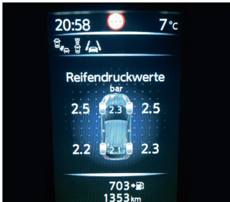
Beispielanzeige eines direkt messenden Systems.
