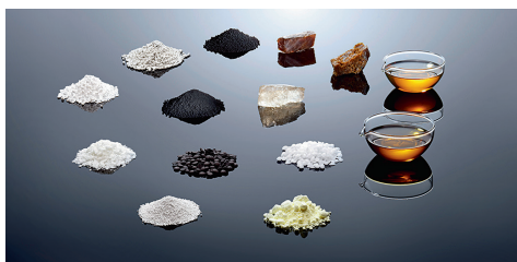
Die verschiedenen Inhaltsstoffe eines Reifens.
