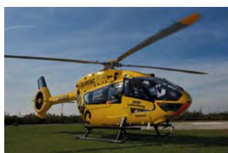
Ein großer Vorteil des neuen Hubschraubers ist die geringere Lärmbelastung. Durch den ummantelten Heckrotor verursacht er nur noch einen Schalldruck von rund 70 Dezibel bei Start und Landung.
