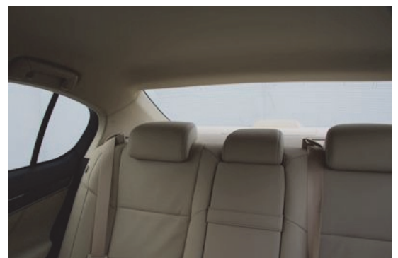
Breite Dachsäulen und nicht voll versenkbare Kopfstützen verhindern eine gute Sicht nach schräg hinten.
