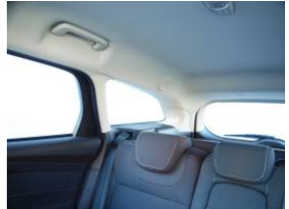
Trotz versenkbaren Kopfstützen wird die Sicht nach schräg hinten durch die breiten Dachsäulen beeinträchtigt.
